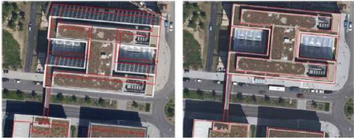
Ortofoto convencional (izquierda) vs. Ortofoto verdadera (derecha).
